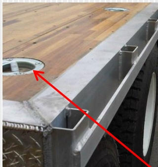
Ancrage au plancher
